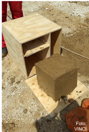
Transport in vorgefertigter Holzbox allseitig mit Wachs umgeben → kein Austrocknen
